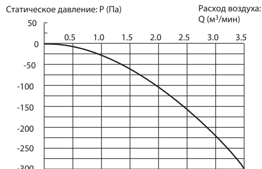
Расход приточного воздуха (подача воздуха в блок)
